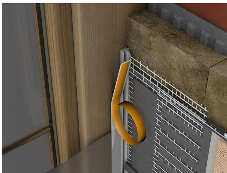
Näide liiteprofili paigaldamisest krohvisüsteemi.
